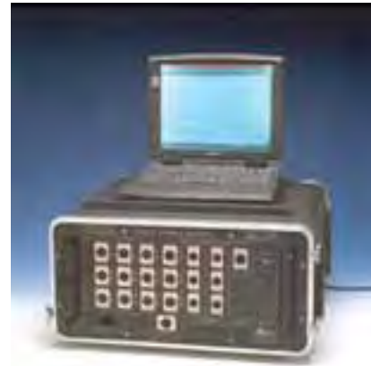
Fig. 2.4a Zensol CBA-32P instrument
